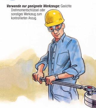
Frage den Dichtungshersteller und/oder die technische Abteilung deiner Firma bezüglich Empfehlung für korrekte Drehmoment Spezifikation.
