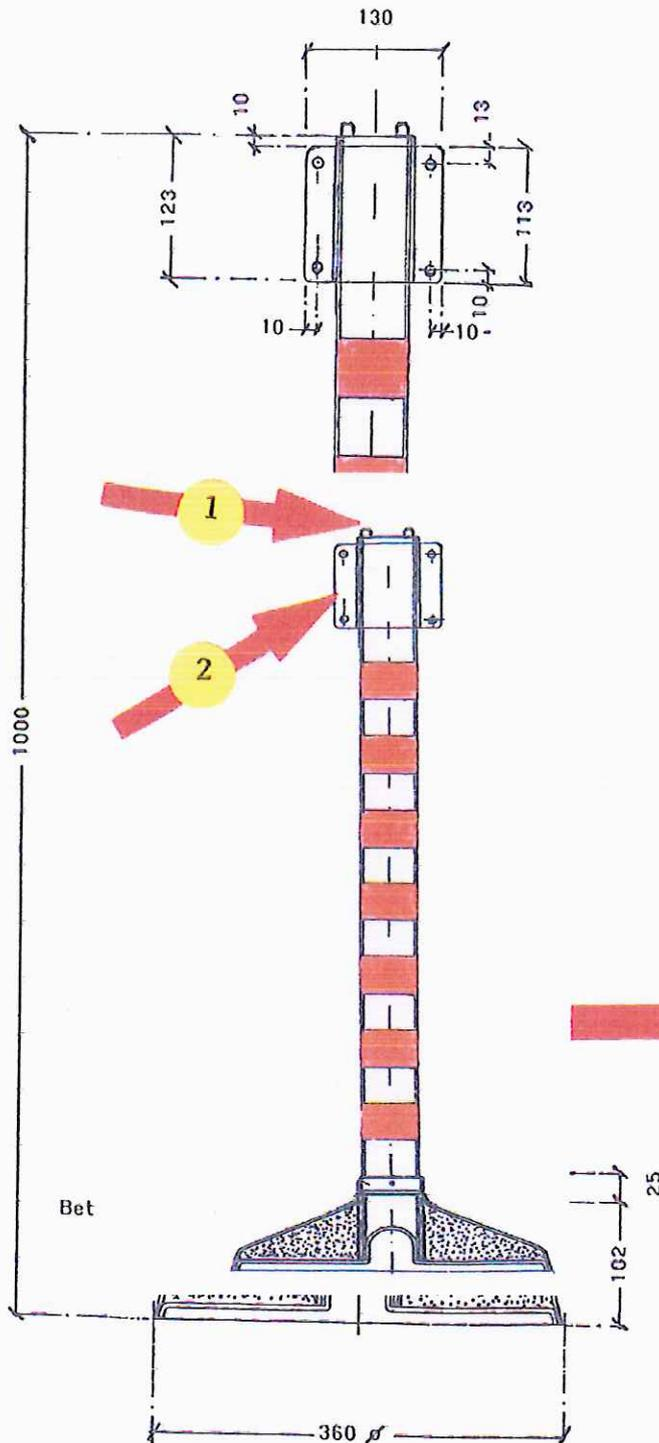
Transportable, wetterbeständige und wartungsfreie Kettenständer als universelles Absperrsystem, voll aus Kunststoff, schwer entflammbar, mit auffälliger „rot-weißer“ Warn-Markierung.
