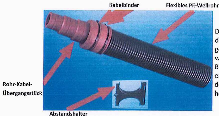
Die vorgegebenen Abstände durch die Abstandshalter gewährleisten einen gas- und wasserdichten Einbau in Beton und Mörtel und ermöglichen die Abteilung der Verlustwärme von hochbelasteten Kabeln.
